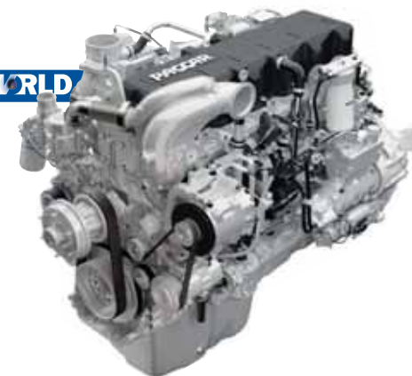
PACCAR MX motor található a Kenworth és Peterbilt kamionokban, 380-tól 485 lóerő teljesítményig, 2400 Nm nyomatékkal.
