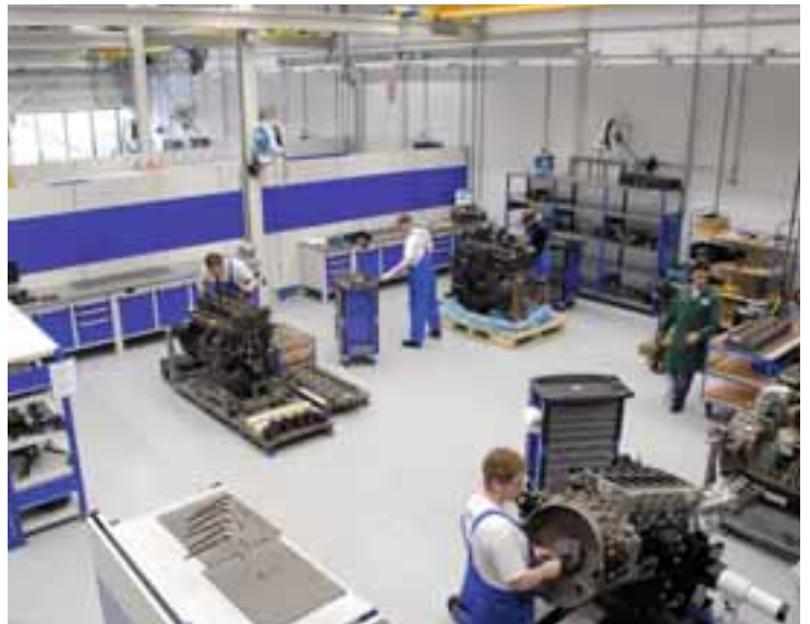
Das neue DAF Engine Test Center, mit dem rund 80 weitere Facharbeitsplätze geschaffen wurden, verfügt über drei Etagen. Das Untergeschoss beherbergt technische Anlagen. Die Prüfstände und Testbereiche befinden sich im Erdgeschoss, während der gesamte erste Stock von Vorrichtungen zur Luft- und Wasseraufbereitung eingenommen wird. Diese Anlagen können pro Stunde bis zu 36.000 m³ Luft pro Prüfstand fördern, die Motoren mit Wasser kühlen, geregelte Verbrennungsluft zuführen und überwachte Abgase bei reduziertem Lärmpegel abführen.
