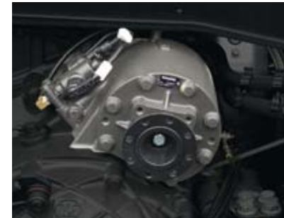
De efficiënte en krachtige motor-PTO levert vermogens tot 150 kW .
